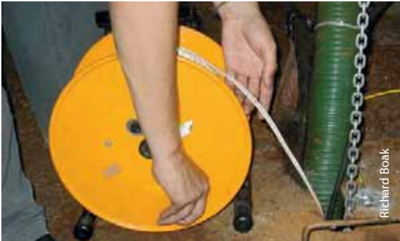
Photo 2 : Sonde piézométrique manuelle
